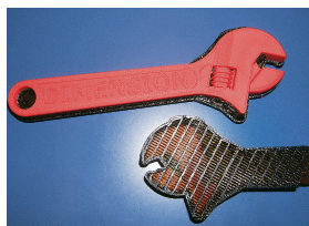
Schichtweise aufgebaut: Die Stützstruktur (schwarz) der Prototypen wird weggewaschen. Foto: M. Ciupek
